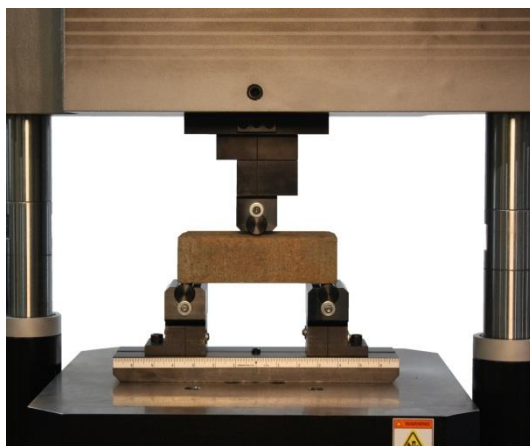
รูปที่ 4 แสดงการทดสอบหาความแข็งแรงต่อแรงดัดโดยใช้แรงกด 3 จุด ที่มา: (บริษัทอินสตรอน (ประเทศไทย) จำกัด)
